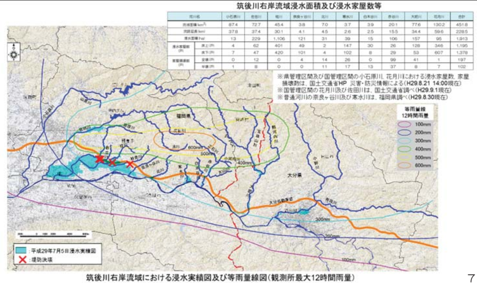
筑後川右岸流域における浸水実績図及び等雨量線図(観測所最大12時間雨量)
