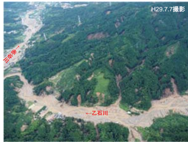
H29.7.7撮影 乙石川の崩壊状況（花崗閃緑岩が主）
