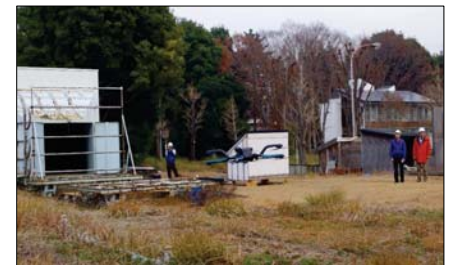
H29.12.8 建築研究所 強風雨発生装置（風速17～18m/sでも安定した飛行を確認） 17
