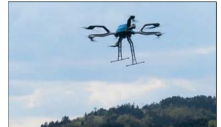
H29.4.25 由良川（風速10m/s強でも安定した飛行を確認）
