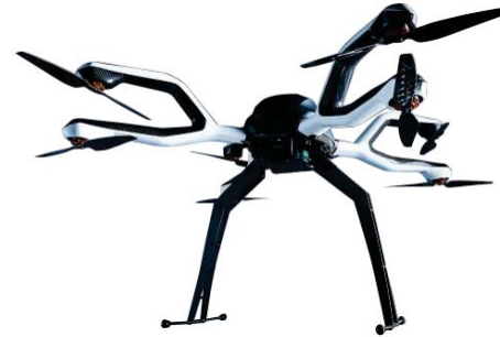
H29.4.25 由良川（風速10m/s強でも安定した飛行を確認）
