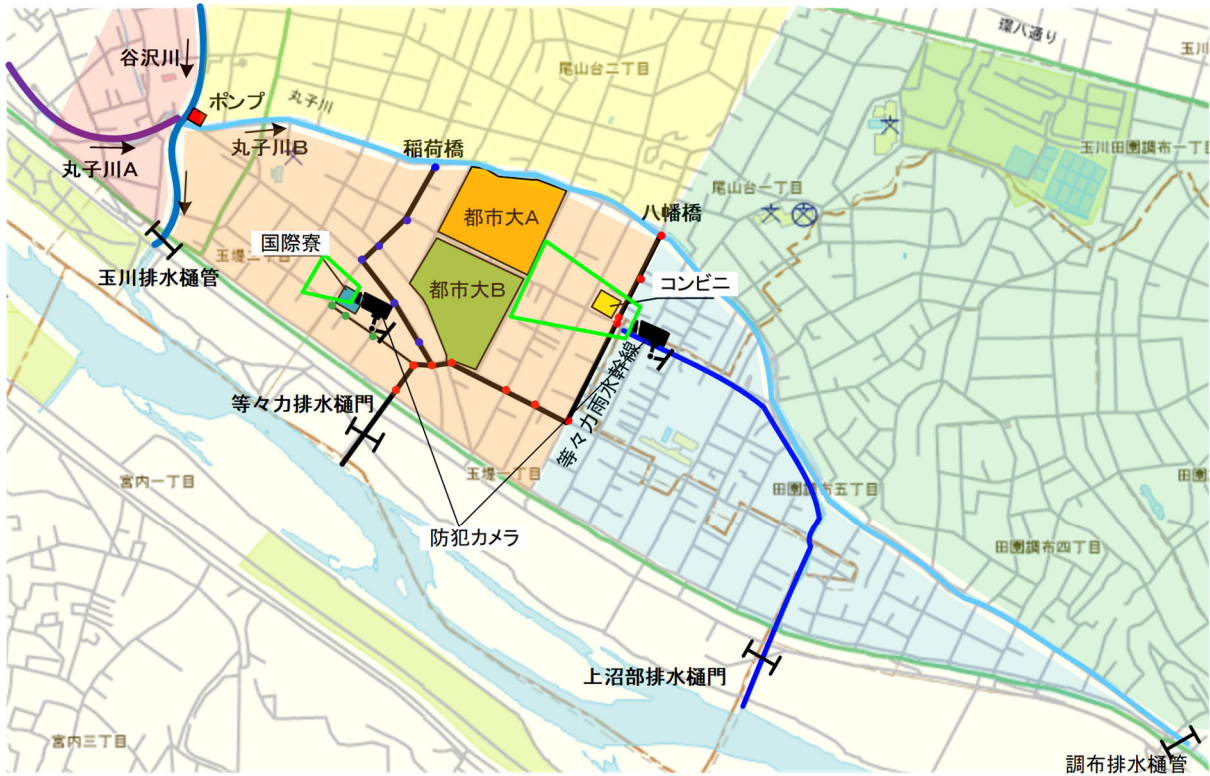
図-1 対象地域の水門 (樋管・樋門・雨水幹線) の概略図と防犯カメラ位置
