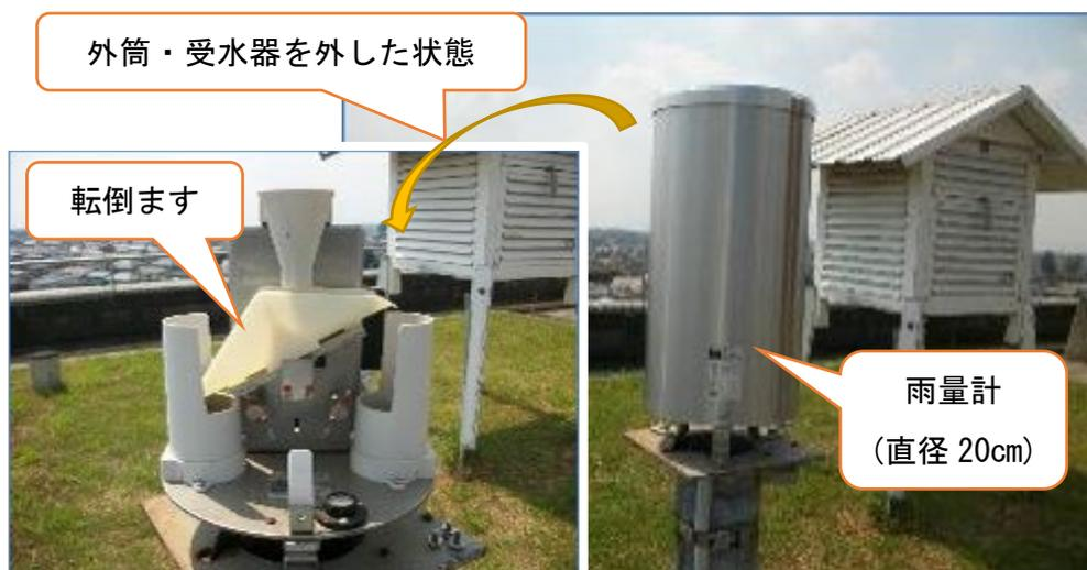
図3 転倒ます型雨量計
