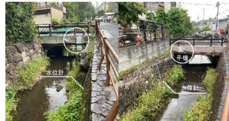
丸子川 2 か所に LoRa 通信による水位計を設置
