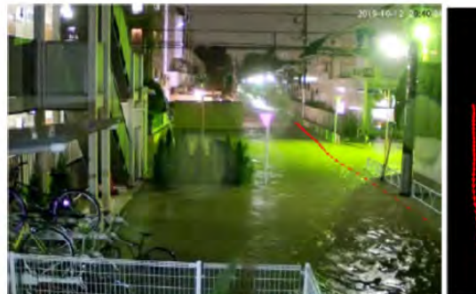
防犯ビデオから漂流物のトラッキングによる流速・流向の時間変化の把握
