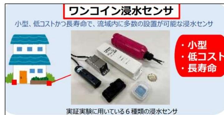
冠水センサの例：国土交通省ワンコイン浸水センサ実証実験パンフレットより
