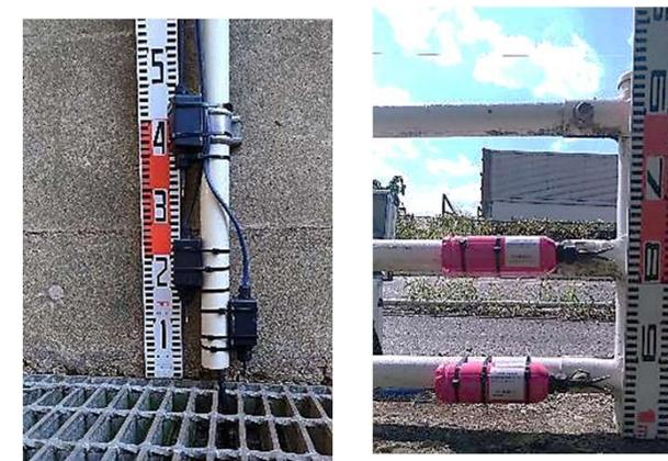
複数の高さの水位を検出するためのセンサの設置例
