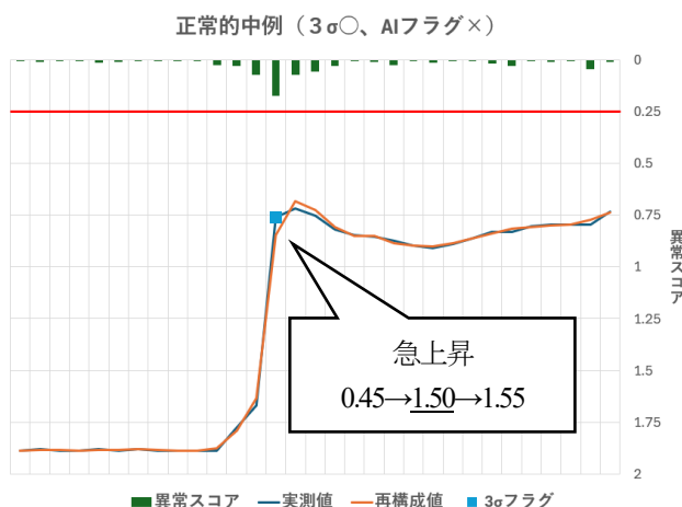
図-9 LSTM-AE および 3\sigma モデルによる異常検出結果の比較 (2025 年 7 月～9 月 立上がり検証)
