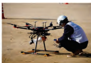
スピーカードローンは拡声器を搭載したドローン
