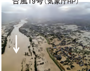
台風19号による千曲川の堤防決壊 (10月13日)(長野市穂保地区)(日本 経済新聞 2019年10月16日)
