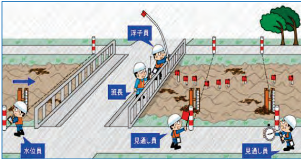
現在の浮子を用いた流量観測（最低5人程度の観測員が必要）
