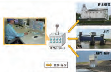
河川管理施設の遠隔化(監視・操作)イメージ
