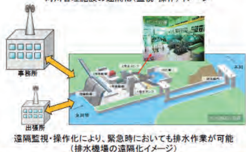
河川管理施設の遠隔化(監視・操作)イメージ
