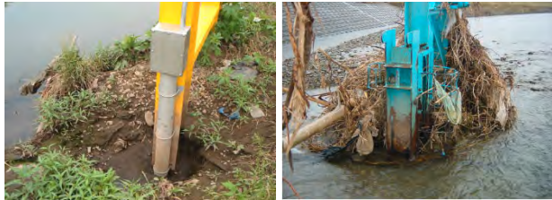
図-3 外的要因の事例 (左：土砂堆積，右：ゴミの付着)
