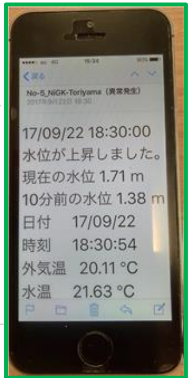
水位上限アラームメール
