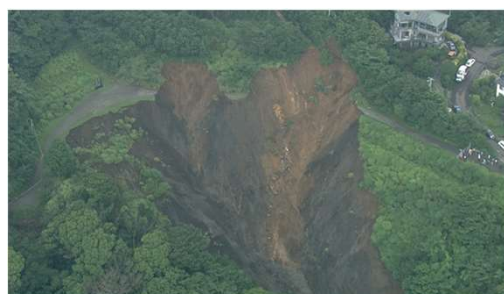
逢初川上流の崩壊源頭部 (静岡県熱海市伊豆山逢初川)
