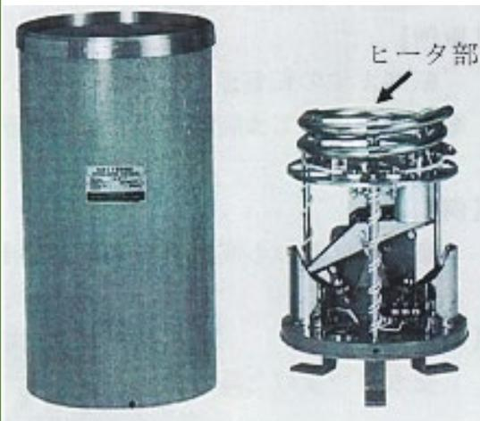
雨量計のカバー内部にヒータを取り付け、低温時ヒータで温めて受水口等の積雪を融かし雨量を計測する
