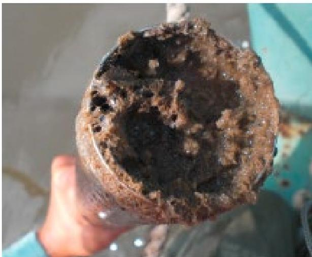
水圧式水位計は、受感部のセンサーで水圧を計測し、水位に変換しています。したがって、受感部のセンサーが、泥や砂などで埋もれ水圧を正しく計測できないと、正確な水位計測ができない。
