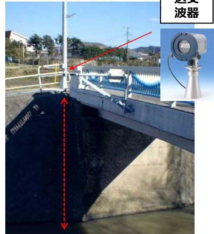
超音波水位計と異なり、温度の影響を受けないため、温度補正の必要がない。
