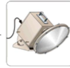
⑤超音波流速計・・・時間差を用いた流速計
