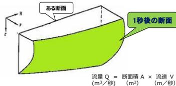
流量観測：流速を測定して、それに断面積を掛けて流量とする。
