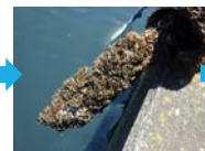
センサー部に貝等がびっしり付着している
