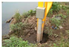
土砂堆積の事例 センサーが埋没して圧力が伝達しなくなり、測定不能となる。
