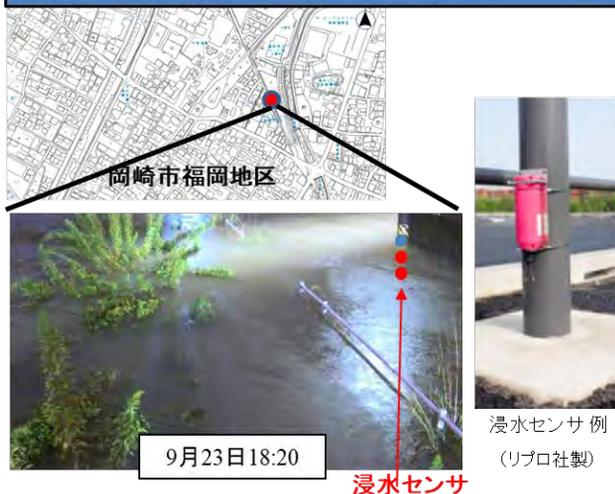
台風15号で岡崎市に設置された浸水センサにより、浸水検知できることを確認
