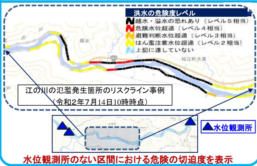
○河川の水位情報に関し、これまでの水位観測所地点のみでの危険度表示から、概ね200m毎の水位の計算結果と左右岸各々の堤防高とを比較することで、**上流から下流まで連続的に洪水の危険度を表示**
