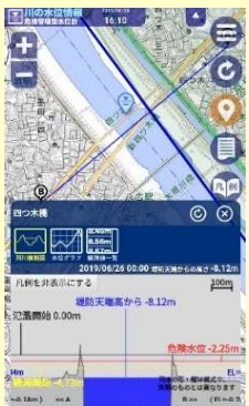
危機管理型水位計による水位情報の提供
