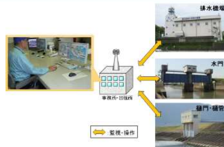
河川管理施設の遠隔化（監視・操作）イメージ
