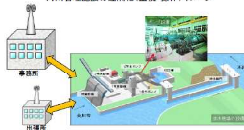
河川管理施設の遠隔化（監視・操作）イメージ
