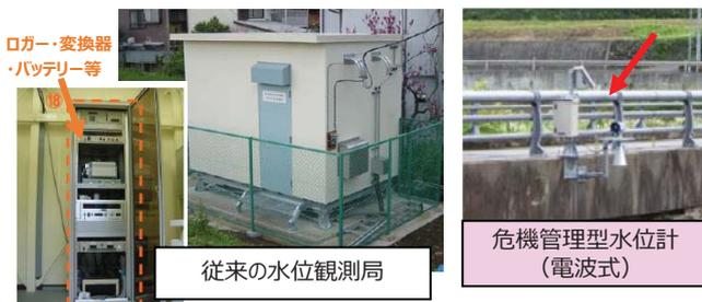
図-2 従来の水位観測局と危機管理型水位計外観
