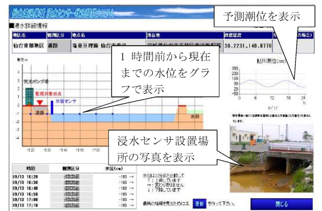
図-8 浸水センサ状況提供システム(詳細情報画面)
